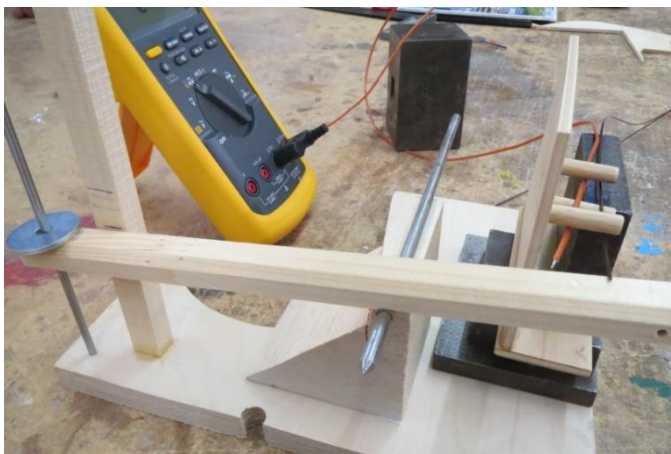
Abbildung 5: selbstgebauter Versuchsaufbau zur Ermittlung des geeigneten Drahtes, eigene Aufnahme
