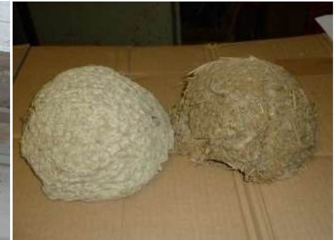
Lehm unter Beigabe v. Sand, Sägemehl u. Weißkalkhydrat ..... und rechts mit Zugabe von Kaffeesatz
