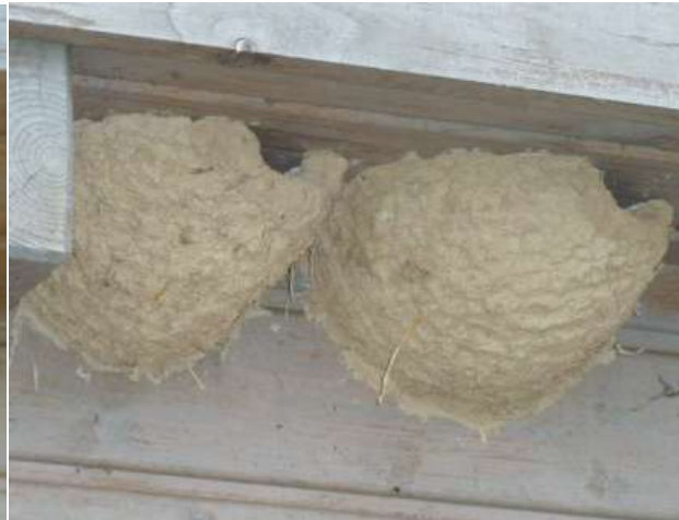
Lehm unter Beigabe v. Sand, Sägemehl u. Weißkalkhydrat ..... und rechts mit Zugabe von Kaffeesatz
